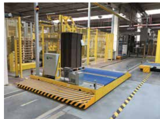
Snímek nahoře a vpravo: Robotické ruce a automatické přepravní dráhy za výsekovým strojem Bobst 203 v opavském závodě vlnité lepenky.
