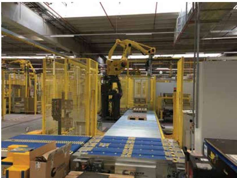
Nová robotická ruka firmy MUK za výsekovým strojem 160 v opavském závodě na výrobu vlnité lepenky.
