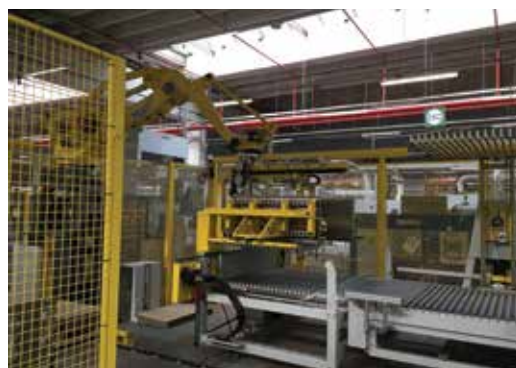
Nová robotická ruka firmy MUK za výsekovým strojem 160 v opavském závodě na výrobu vlnité lepenky.
